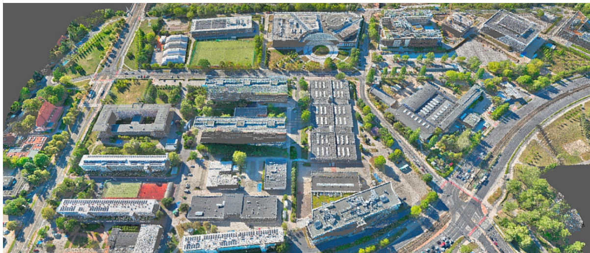
Rysunek 7.6. Mapa Kampusu Warta Politechniki Poznańskiej oparta na surfelach 3D, zbudowana na podstawie danych z sensora LiDAR przenoszonego przez autonomiczny UAV wirnikowy
