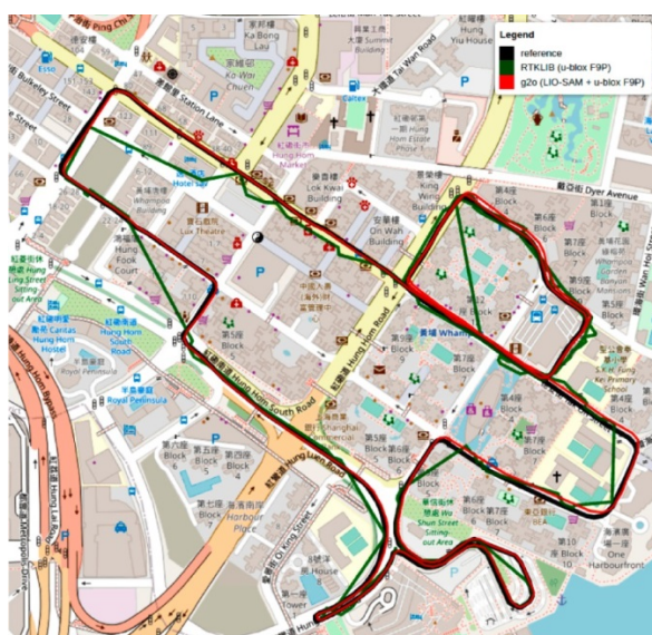
Rysunek 7.8. Przykładowe wyniki zastosowania podejścia do lokalizacji pojazdu w środowisku miejskim opartego na GNSS i SLAM laserowym ze ścisłą integracją w strukturze grafu czynnikowego
